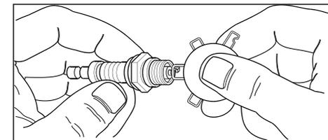
Рисунок 9 – Установка свечи
